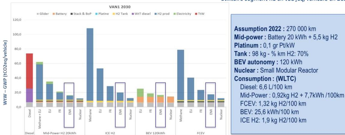
Au regard de cet exemple (véhicule utilitaire du segment K1) les différentes chaines de tractions (moteur thermique diesel, pile à combustible hydrogène – architecture mid-power et full power – électrique à batterie, et moteur thermique hydrogène) ont été évaluées. Les scénarios de "référence" diesel et vaporeformage de méthane pour la production d'hydrogène présente clairement les plus mauvais résultats en terme d'impact sur le réchauffement climatique.
